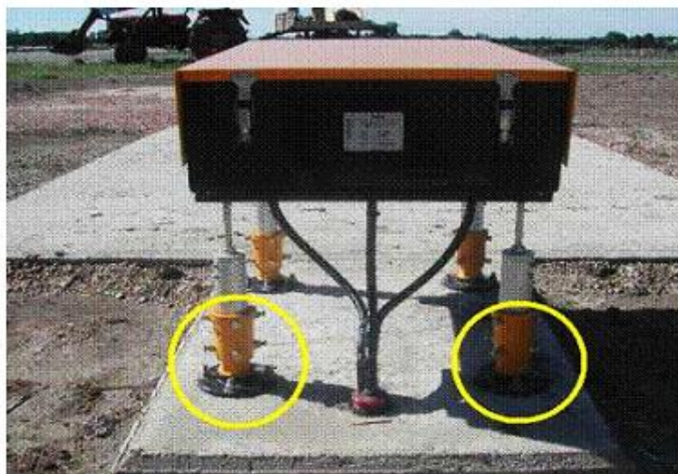
Figura 2-6-5. Ejemplos de Cuplas Frangibles en las instalaciones del PAPI.
